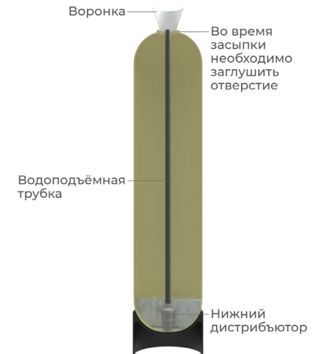
Заполнение фильтра материалом
